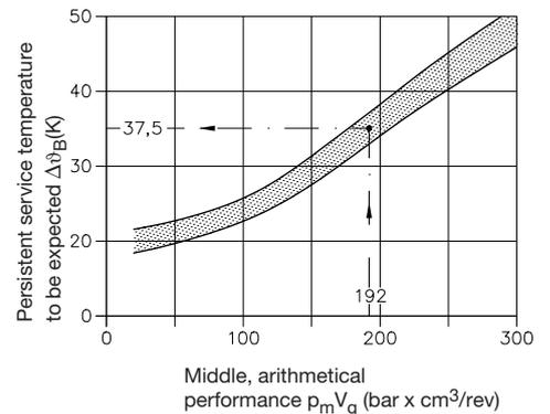
$$\vartheta_{\text{fluid B}} = \Delta\vartheta_B + \vartheta_U$$
